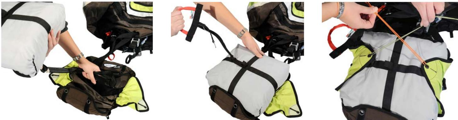
Führen Sie eine dünne Leine (Gleitschirmleine) in die Gummischlaufen, dann fädeln Sie die Ösen des Gurtzeug-Containers auf, beginnend mit den kleinsten, um diese unter Zug zusammenzuziehen. Folgen Sie dabei der Reihenfolge, die im Bild/Zeichnung ersichtlich ist.
