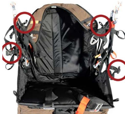
Beim Verbinden des Rettungsschirmcontainers mit dem Gurtzeug ist zu beachten, dass die Verbindungsleine außerhalb des Hauptgurtes und dann in den Aufhängungskarabiner führt.
